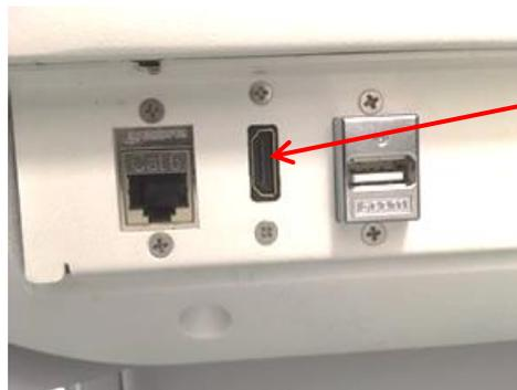
Figura 11: Conector do segundo monitor (HDMI)
