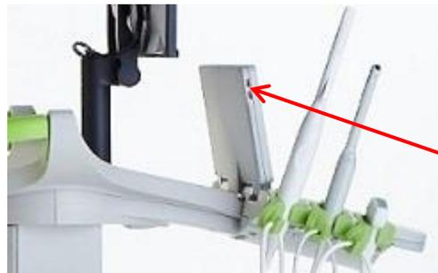
Figura 7: Conectores USB na parte esquerda da tela de toque
